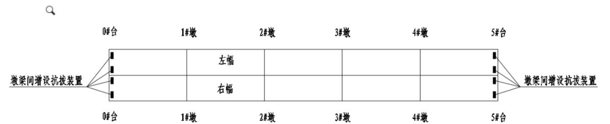
图 2.1-8 加固平面布置示意图
