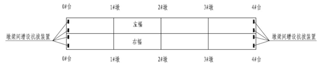
图 2.1-8 加固平面布置示意图
